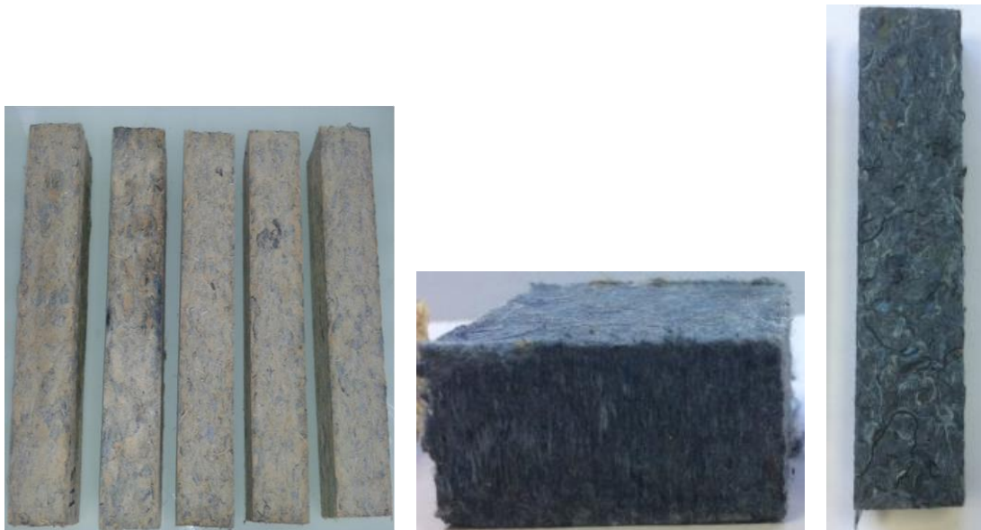
a b c Exemples de matériaux à base de textiles recyclés avec différents liants biosourcés a) chitosane b) alginate c) biopolyester
